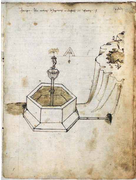
Fig. 3. Taccola, fontana esagonale a caduta e zampillo con misurazione della quota della sorgente che l'alimenta (f. 28r; Palatinus 766, Firenze, Biblioteca Nazionale Centrale).
